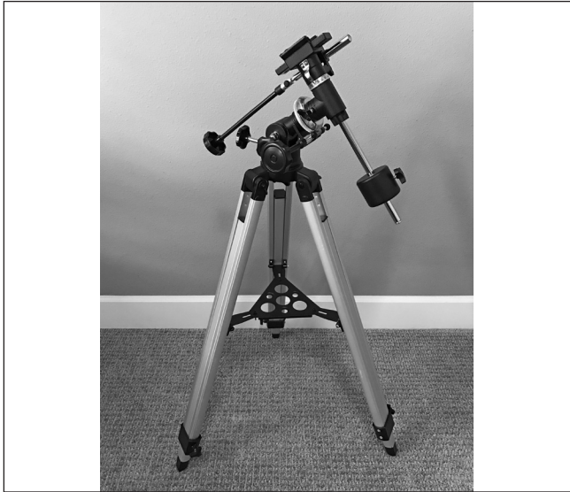
Figura 13. Montura ecuatorial completamente montada.
