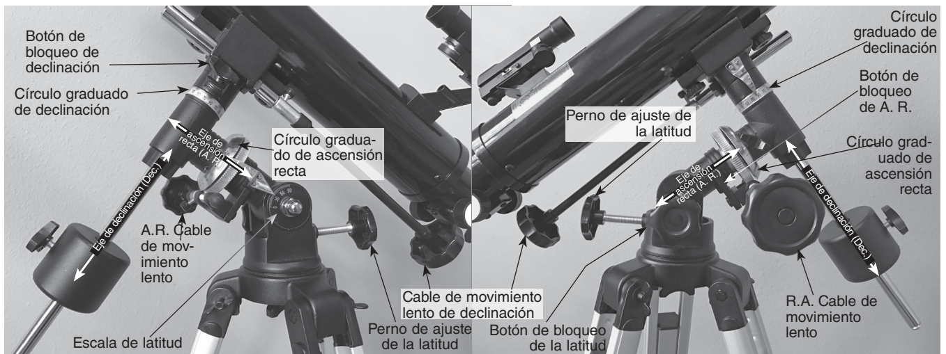
Figura 18. Componentes de la montura ecuatorial, vistos desde ambos lados.
