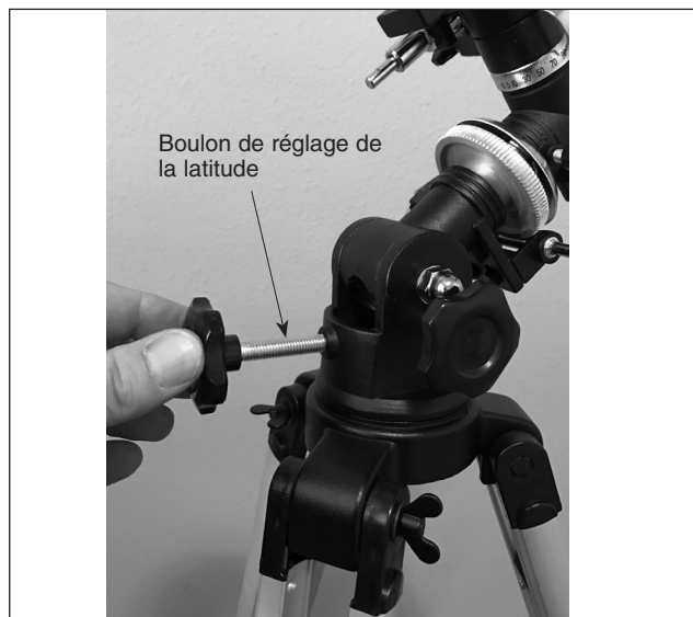
Figure 8. Vissez le boulon de réglage de la latitude.
