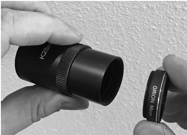
Figure 21. Les oculaires Kellner ont des barilletés filetés pour s'adapter aux filtres optionnels Orion 1.25" (31,75 mm). Un filtre lunaire est utile pour réduire la lumière éblouissante de la Lune et révéler plus de détails de la surface lunaire.
