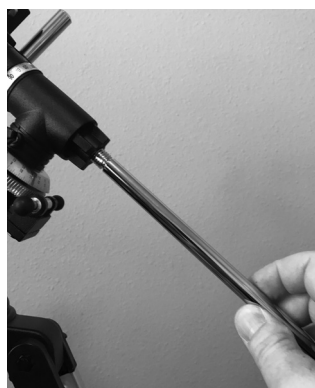
Figure 9. Vissez la barre de contreponds dans le boîtier de déclinaison.
