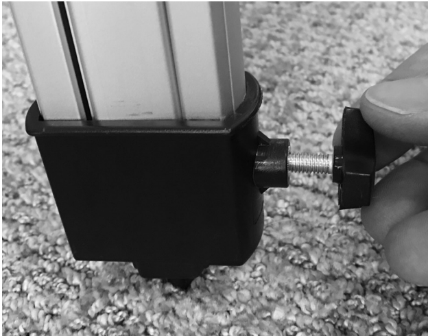
Abbildung 4. Schrauben Sie eine Rändelschraube für die Stativbeinarretierung in jedes der Beine. Seien Sie dabei vorsichtig und ziehen Sie die Schraube nicht zu fest.
