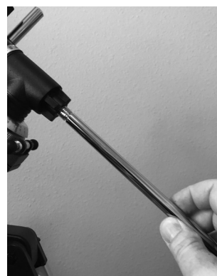
Abbildung 9. Schrauben Sie die Gegengewichtsstange in das Gehäuse auf der Dek-Achse ein.
