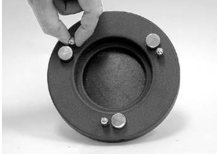
Figure 11. Les trois petites vis qui maintiennent le miroir primaire en place doivent être desserrées avant de procéder à tout ajustement.
