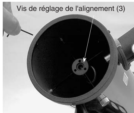
Figure 10. Ajustez l'inclinaison du miroir secondaire en desserrant ou en serrant les trois vis d'alignement à l'aide d'une clé hexagonale de 2 mm.
