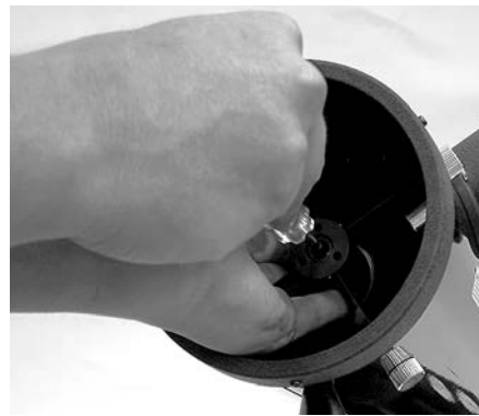
Figure 9. Pour centrer le miroir secondaire sous le porte-oculaire, maintenez le support du miroir en place d'une main tout en ajustant le boulon central à l'aide d'un tournevis cruciforme. Ne touchez pas la surface du miroir !
