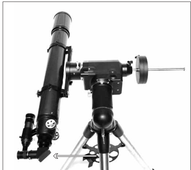
Figura 7. Empuje suavemente el telescopio horizontalmente para determinar la dirección del desplazamiento del eje óptico.
