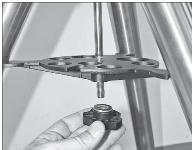
Figure 3. Installation du distributeur des montants du trépied, qui est aussi un porte-accessoire/porte-oculaire.
