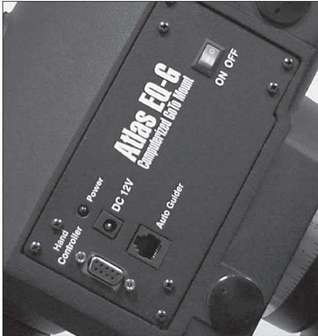
Figura 14. Panel de la unidad de la montura Atlas EQ-G
