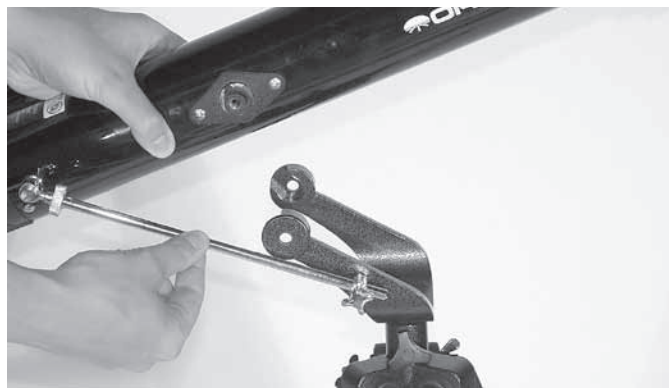
Figura 4. Installazione del tubo ottico nel "giogo" della montatura altazimutale.
