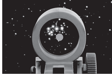
Figure 7. Le EZ Finder II superpose un petit point rouge sur le ciel, indiquant l'endroit où le télescope est pointé.
