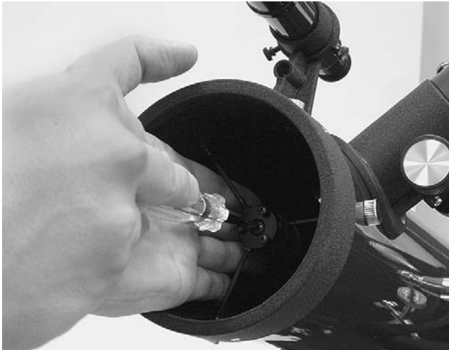
Figura 9. Para centrar el espejo secundario bajo del enfocador, sujete el secundario en su lugar con los dedos mientras ajusta el tornillo primario con un destornillador de estrella. No toque la superficie del espejo.
