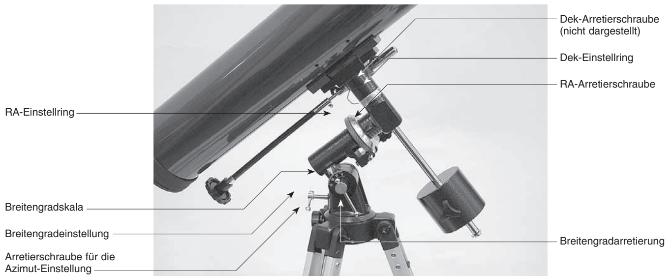
Abbildung 2. Die parallaktische Montierung des SpaceProbe 3 EQ-Teleskops.
