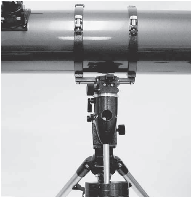
Figure 8. Le tube optique doit faire un angle de 90° avec l'axe d'ascension droite afin de voir à travers le chercheur polaire
