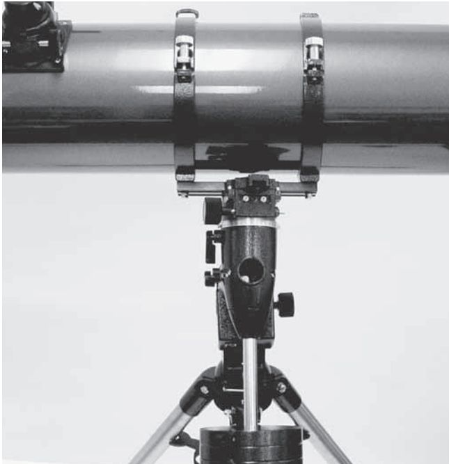
Figura 8. El tubo óptico debe formar un ángulo de 90^\circ con respecto al eje de ascensión recta con el fin de ver a través del telescopio buscador de eje polar
