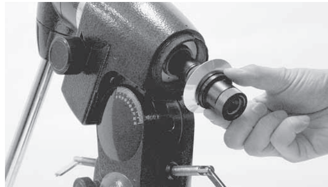
Figura 7b. Instalación del telescopio buscador de eje polar opcional.
