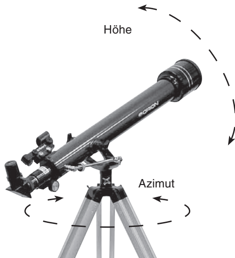
Abbildung 5: Das Observer 60-Teleskop besitzt zwei Bewegungsachsen: Höhe und Azimut.
