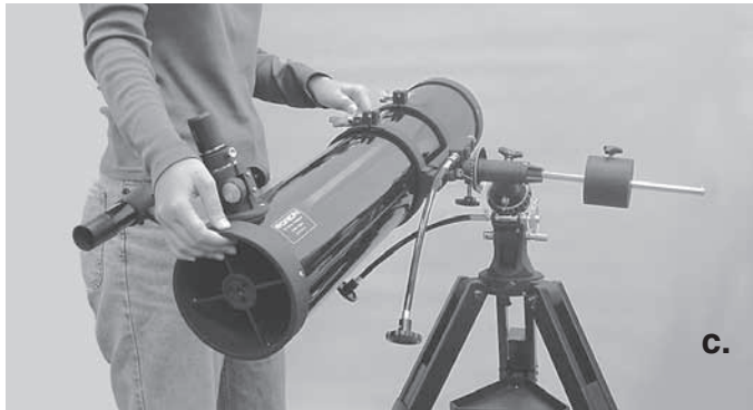
Figura 4a, 4b, 4c, 4d. Per un corretto funzionamento della montatura equatoriale, il tubo del telescopio deve essere in equilibrio su entrambi gli assi di ascensione retta e declinazione. (a) Con la manopola di blocco dell'ascensione retta non serrata, fare scorrere il contrappeso lungo la barra fino a controbilanciare il tubo. (b) Se si lascia andare il tubo con entrambe le mani, non deve spostarsi verso l'alto o il basso. (c) Con la manopola di blocco della declinazione non serrata, allentare di alcuni giri i morsetti di blocco degli anelli del tubo e fare scorrere il telescopio in avanti o indietro negli anelli. (d) Se il tubo è in equilibrio sull'asse di declinazione, non si sposta quando viene lasciato andare.
