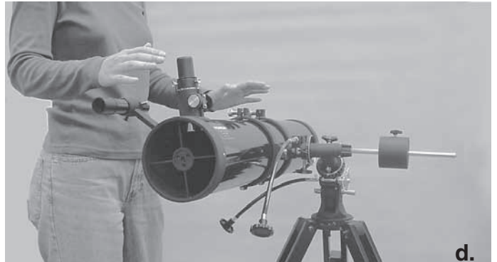
Figura 4a, 4b, 4c, 4d. Per un corretto funzionamento della montatura equatoriale, il tubo del telescopio deve essere in equilibrio su entrambi gli assi di ascensione retta e declinazione. (a) Con la manopola di blocco dell'ascensione retta non serrata, fare scorrere il contrappeso lungo la barra fino a controbilanciare il tubo. (b) Se si lascia andare il tubo con entrambe le mani, non deve spostarsi verso l'alto o il basso. (c) Con la manopola di blocco della declinazione non serrata, allentare di alcuni giri i morsetti di blocco degli anelli del tubo e fare scorrere il telescopio in avanti o indietro negli anelli. (d) Se il tubo è in equilibrio sull'asse di declinazione, non si sposta quando viene lasciato andare.
