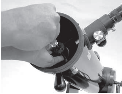
Figure 17. Pour centrer le miroir secondaire sous le porte-oculaire, maintenez le support du miroir en place d'une main tout en ajustant le boulon central à l'aide d'un tournevis cruciforme. Ne touchez pas la surface du miroir !
