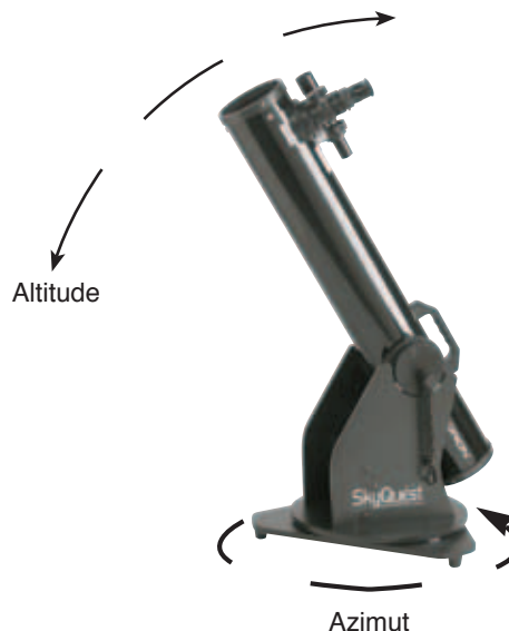
Figure 10. Le SkyQuest a deux axes de mouvement : vertical ou altitude (haut/bas) et horizontal ou azimut (gauche/droite).
