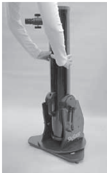
Figure 5. Réglez le tube optique sur le « berceau » de la base de sorte que les paliers latéraux d'altitude du tube reposent sur les « patins » de plastique blanc. Positionner le télescope comme illustré de manière à ce qu'il ne tombe pas avant que le système CorrectTension ne soit installé et enclenché.
