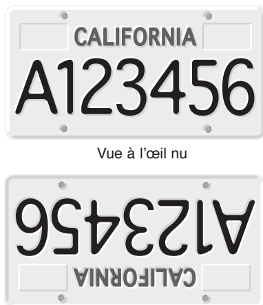
Figure 12. L'image aperçue dans un télescope est à l'envers. C'est le cas pour le SkyQuest XT4.5. Mais l'image aperçue dans le chercheur sera dans le bon sens, telle que vue à l'œil nu.
