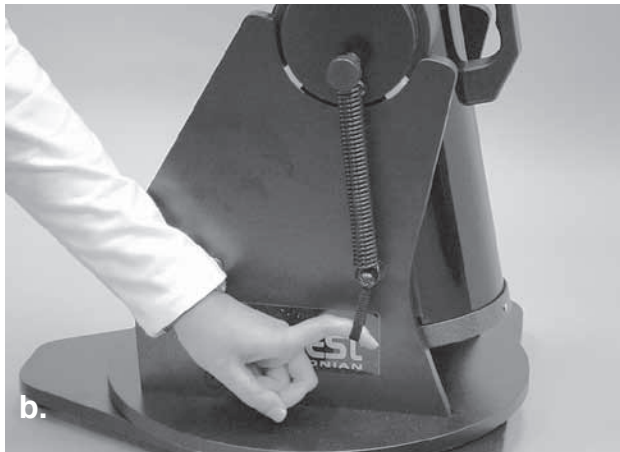
Figure 7 : (a) Pour attacher le ressort à la base, saisissez l'anneau et tirez le ressort vers le bas à l'aide de votre index. (b) Tout en tirant vers le bas, glissez l'anneau du ressort sur la tête de vis et dans l'entretoise étroite en nylon, et relâchez l'anneau.
