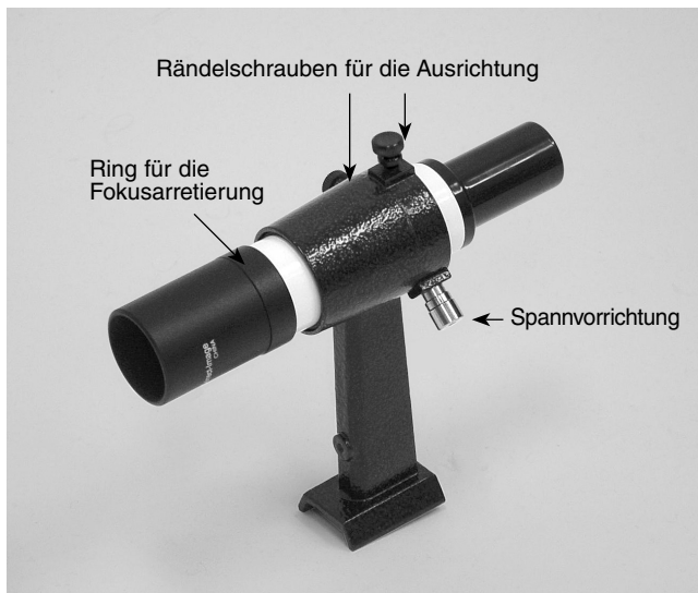
Abbildung 2a. Das 6x26-Sucherfernrohr mit Bildkorrektur und Halterung.
