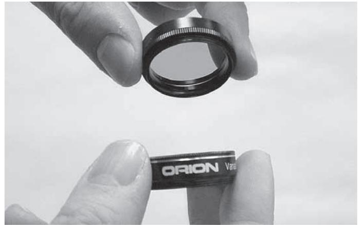
Figura 1. Montaje del filtro polarizador variable de 3,18 cm
