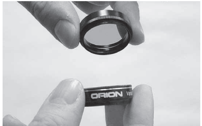
Figure 1. Montage du filtre polarisant variable 1.25" (31,75 mm)
