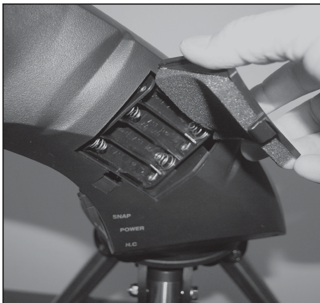
Figura 15. La montatura StarSeeker IV è alimentata da otto batterie AA fornite dall'utente, che sono installate nel braccio della montatura.
