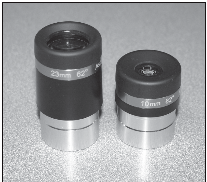
Figura 14. I telescopi StarSeeker IV sono dotati di oculari a largo campo da 23 mm e 10 mm.
