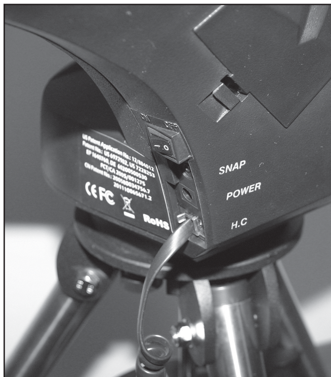
Figura 16 Le porte elettroniche per l'unità di controllo manuale e una batteria da 12 VCC opzionale si trovano alla base del braccio della montatura. La porta SNAP permette il controllo di una fotocamera DSLR con un apposito cavo.
