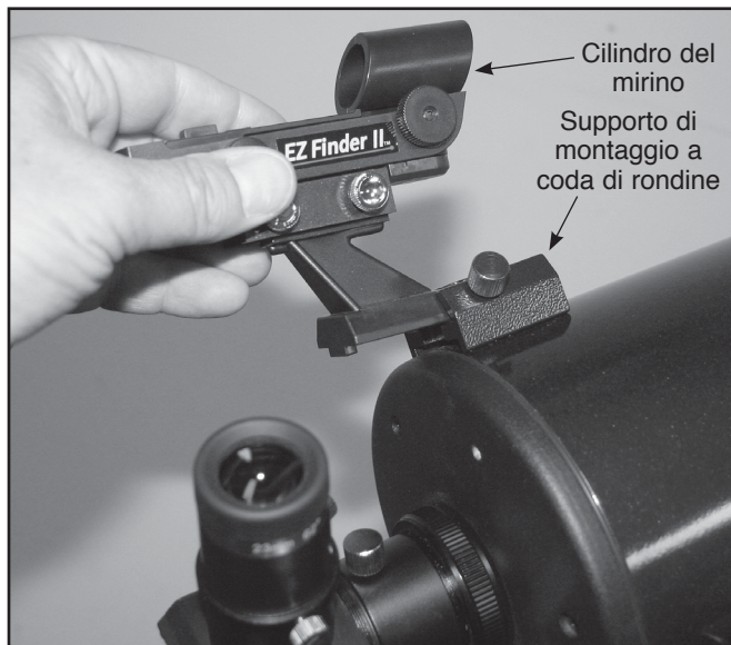
Figura 12. Inserire il mirino EZ Finder II nel supporto a coda di rondine orientandolo come indicato e fissarlo con la vite zigrinata.
