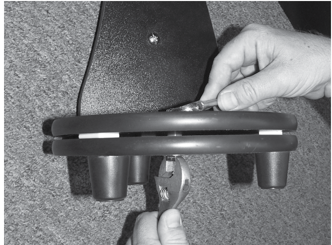
Figure 11 : ajustements facultatifs pour le réglage de la tension de l'azimut
