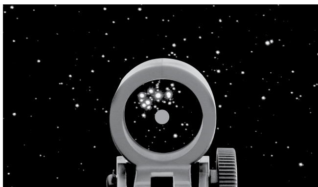
Figure 5. Le EZ Finder II superpose un petit point rouge sur le ciel, indiquant l'endroit où le télescope est pointé.
