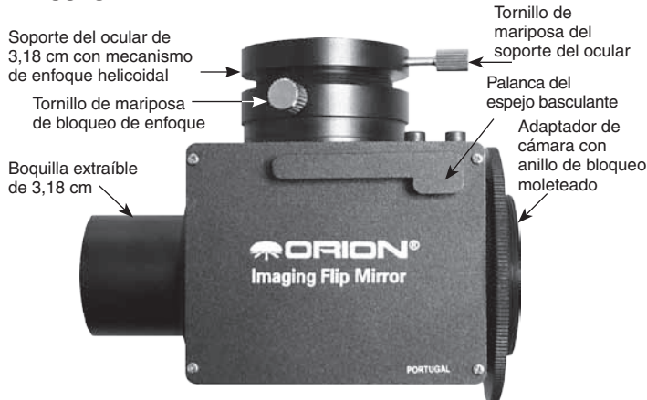
Figura 1. Espejo basculante de fotografía y sus componentes
