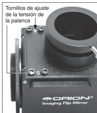
Figura 6. (arriba) Los dos tornillos de cabeza hueca plateados situados encima de la palanca ajustan la tensión de la palanca.
